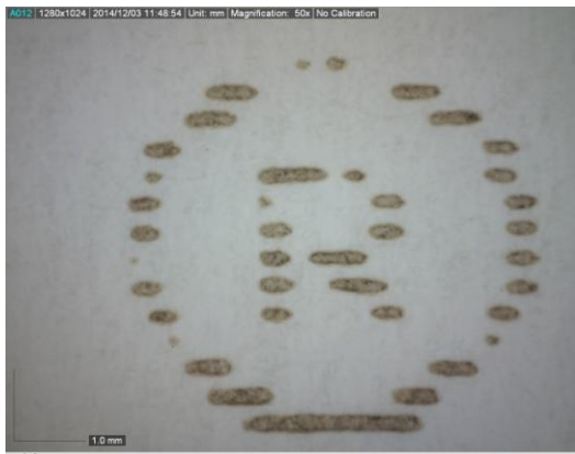
2.7 pav. GoldenLase JG-4185 graviruotas elementas ant popieriaus (240x)
