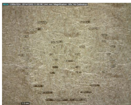
2.10 pav. GoldenLase JG-4185 graviruotas elementas ant kraft popieriaus (240x)
