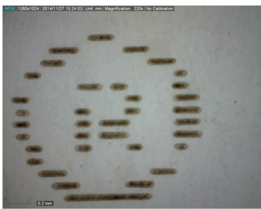
2.3 pav. Yueming PN-1080 graviruotas elementas ant popieriaus (240x)
