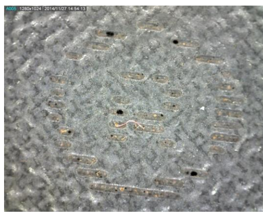
2.4 pav. Yueming PN-1080 graviruotas elementas ant dirbtinės odos (240x)
