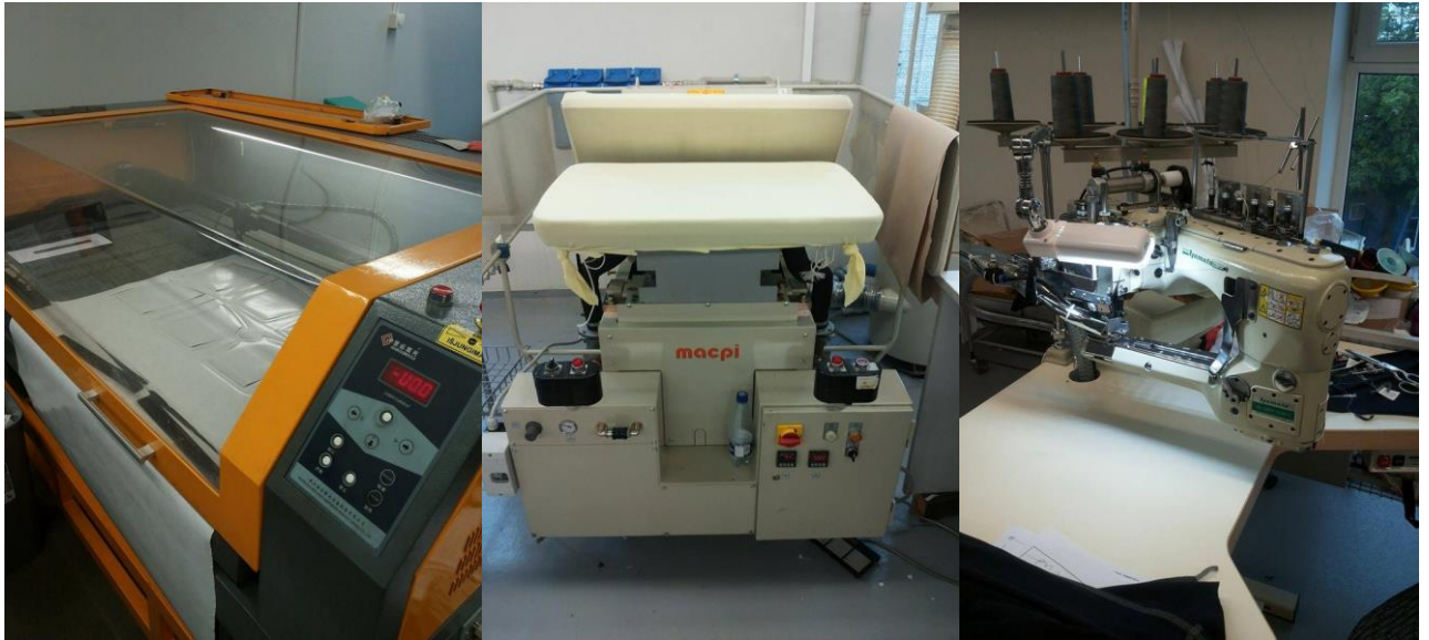
36 pav. Naudojami įrenginiai (a- pjovimo lazeris, b- termopresas, c- ketursiūlis fletlokas)
