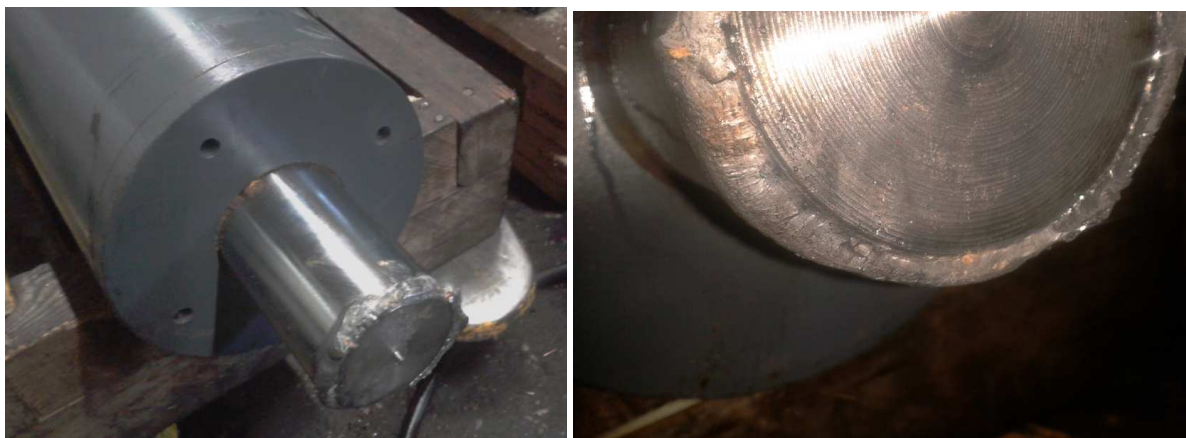
2.6 pav. Atitrūkusi hidraulinio cilindro ausis
