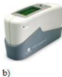
30 pav. Paviršiaus pokyčių matavimo prietaisai: a -spektrofotometras „X RiteColor“ [27]; b - Blizgometras „Uni Gloss 60Plus“ [28]
