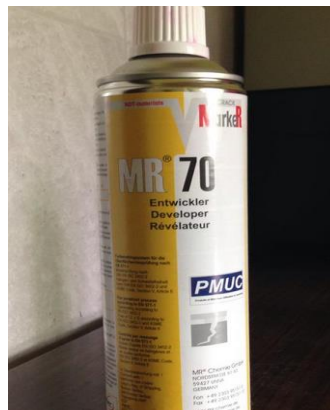
3.11 pav. Kapiliarinei defektoskopijai naudotas ryškalas MR 70
