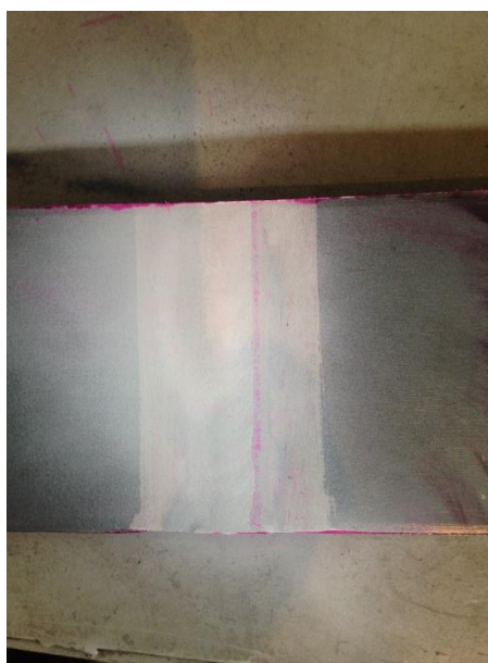
3.20 pav. Bandinys atlikus skvarbiųjų dažalų kontrolę.
