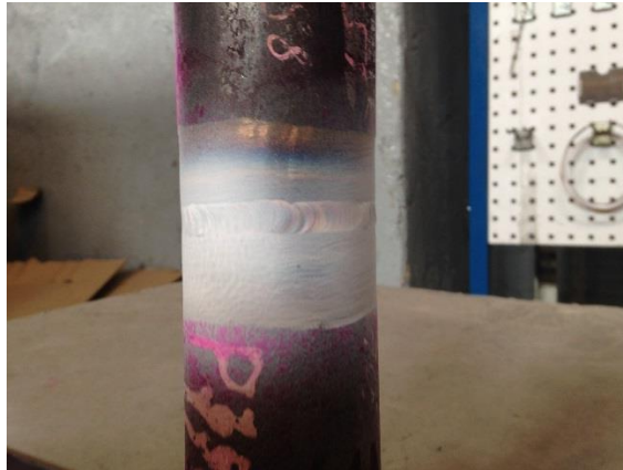
3.12 pav. Bandinys suvirintas rankiniu TIG būdu po skvarbiųjų dažalų kontrolės.
