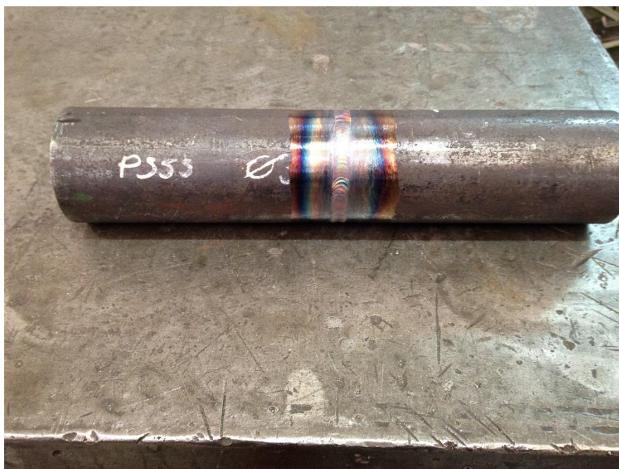
3.5 pav. Bandinys suvirintas rankiniu TIG būdu.
