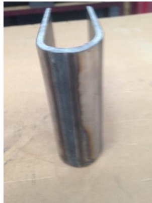
3.17 pav. Bandinys po lenkimo bandymo
