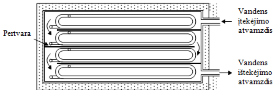
VIII. pav. tiesioginio plėtimosi talpos garintuvas. Skerspjūvis.
