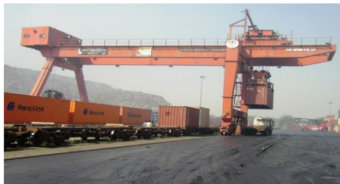
1.9 pav. Tiltinis keliamasis kranas (RMGC)
