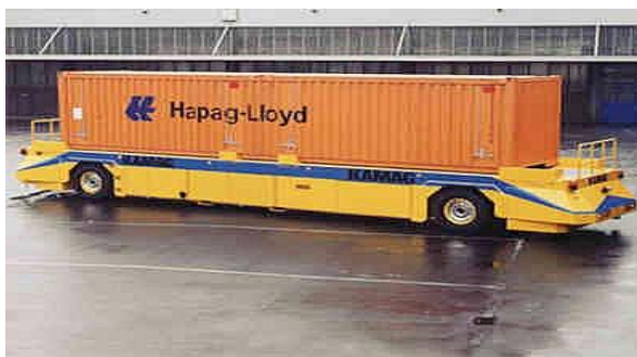
1.6 pav. Automatizuota savaeigė transporto priemonė (AGV)
