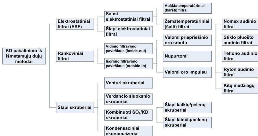
2 pav. Kietųjų dalelių emisijų mažinimo įrenginių ir metodų klasifikacija
