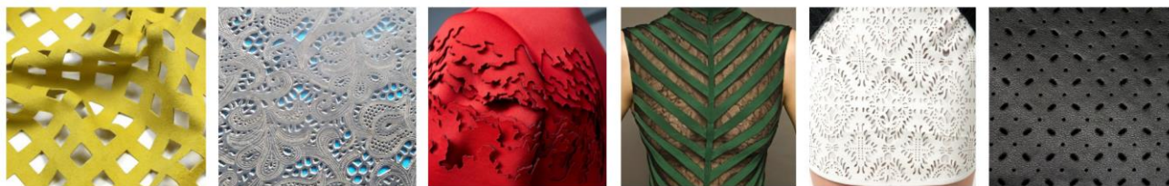
16 pav. Lazериu išpjaustyti įvairios pluoštinės sudėties audiniai ir oda
