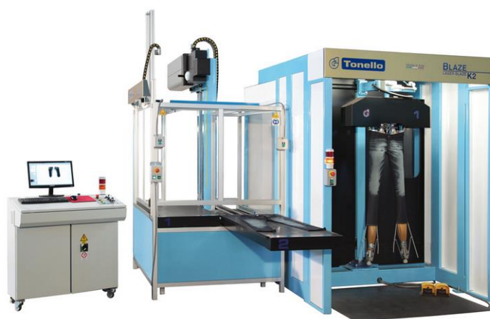
19 pav. Bandinių apdorojimui naudota lazerinė technologija „Tonello laser blase TM 250/350“ [22]
