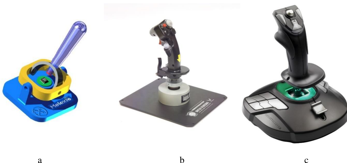
22 pav. „Melexis“ jutiklis ir vairalazdės jo pagrindu: a - „MLX90333 3D“ jutiklis [14]; b - „Thrustmaster Warthog“ [15]; c - „T.16000M“ [16]
