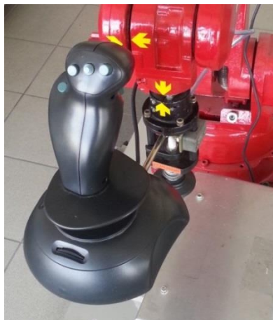
5 pav. Poveikio įtaisas sumontuotas ant pramoninio roboto
