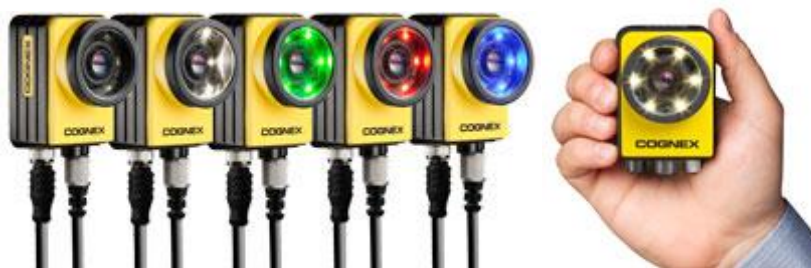
2.6 pav. „Cognex In-Sight 7000“ serijos jutikliai su automatiu fokuso galimybėmis ir integruotu apšvietimo moduliu
