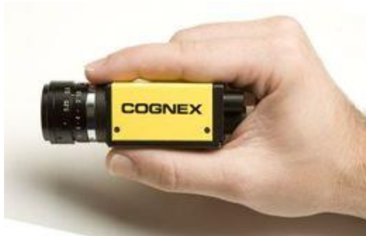
2.7 pav. „Cognex In-Sight Micro“ „viskas viename“ sistema ( angl. All-In_One ).
