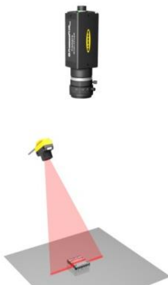
2.10 pav. Objekto geometrinių savybių radimas naudojantis struktūrizuotos šviesos metodu.
