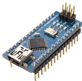
3.2.1 pav. DCCDuino Nano programatorius su ATmega328P-PU mikroprocesoriumi.
