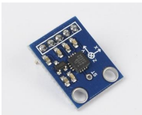
3.3.1.2 pav. Analoginio akcelerometro modulis GY-61 (ADXL335).
