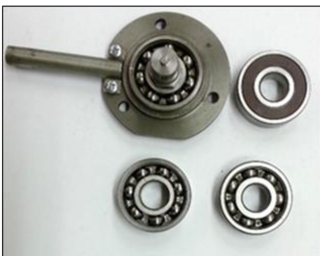
3.2 pav. Sukurto specialaus laikiklio ir kelių 6303 tipo guolių vaizdas
