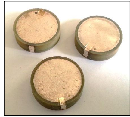
3.22 pav. Sulituotos penkių sluoksnių pjezokeraminių plokštelių paketai
