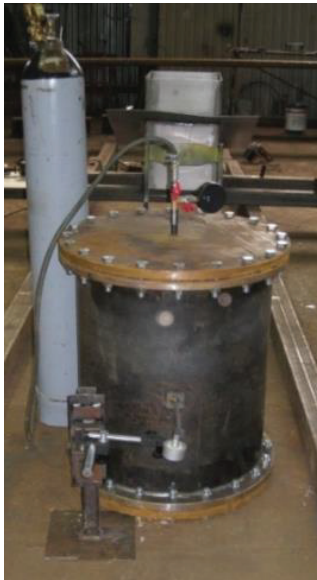
2.17 pav. Slėgio indo su gofruoto korio cilindrine sienele eksperimentinio tyrimo standas
