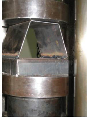
2.20 pav. Bandinys „Amsler“ bandymų mašinoje
