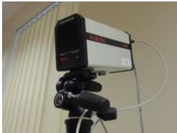
4.1 pav. ProReflex MCU 500 Type 170 241 kamera
