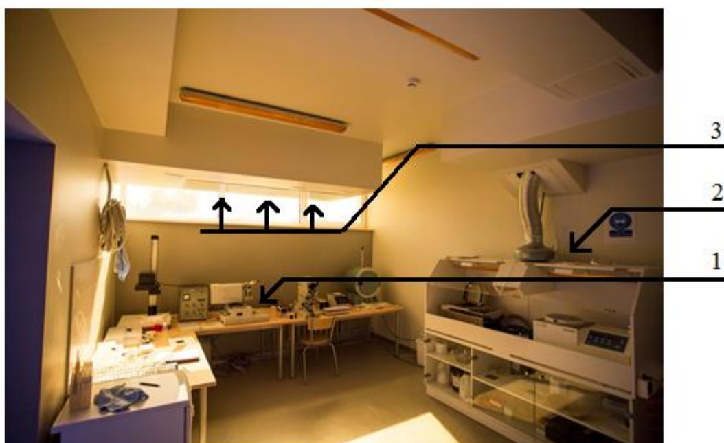
11 pav. Fotolitografijos procesų kambarys. 1 – optinis eksponavimo įrenginys ir darbo vieta, 2 – traukos spinta drėgnumams procesams, 3 – oro tiekimo grotelės
