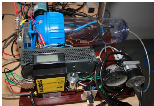
24 pav. Prototipo testavimo kamera: a) principinė testavimo kameros schema, b) testavimo kamera paruošta darbui su slėgio jutikliais
