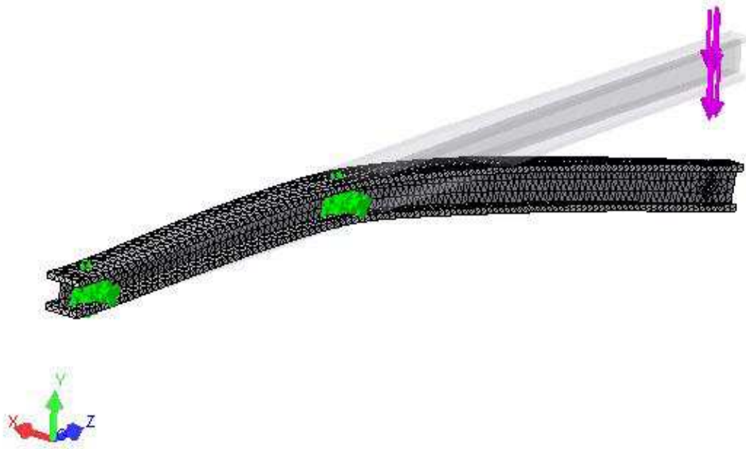
5.2.12 pav. Bandomojo lonžerono apkrauto statinė jėga bendras vaizdas
