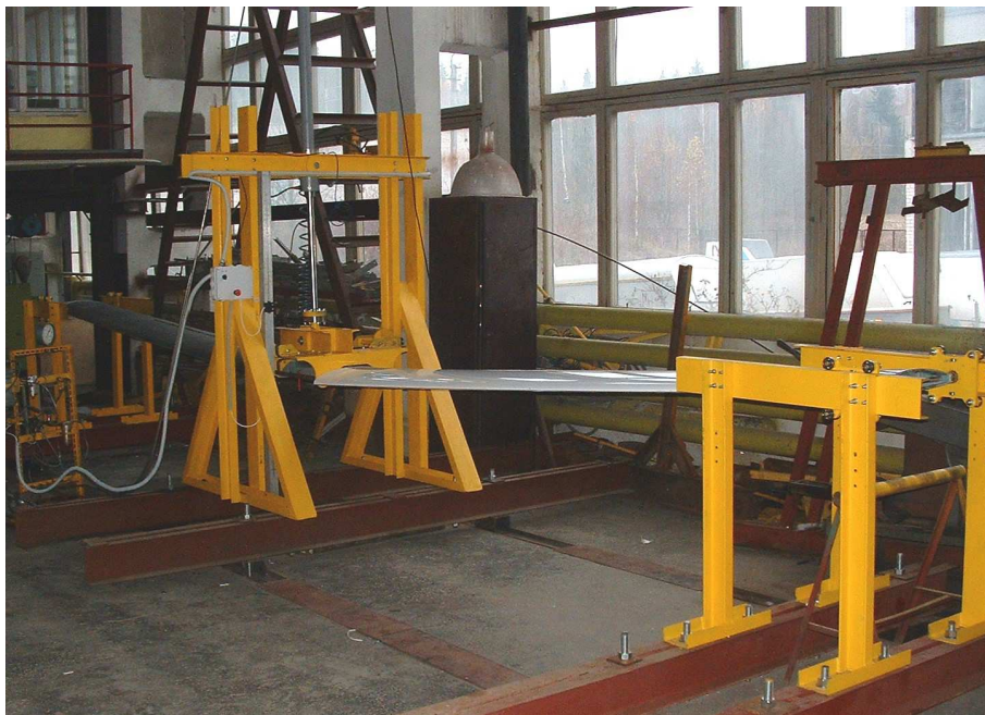
5.2.13 pav. KTU suprojektuotas ir pagamintas sklandytuvo sparno resurso bandymo stendas
