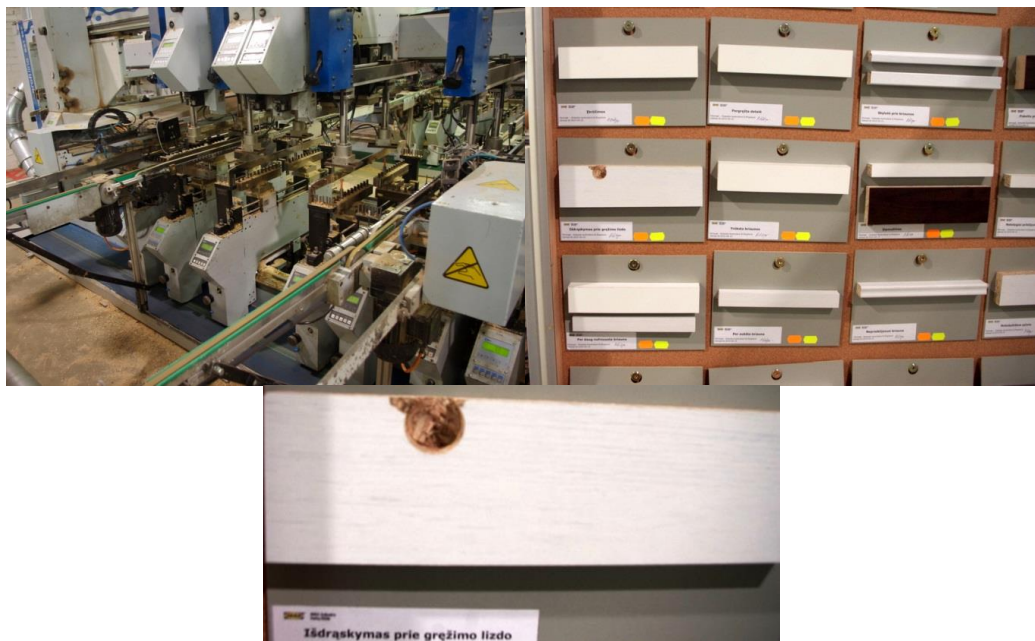
2 pav. Skylių išgręžimo staklės bei defektų pavyzdžiai
