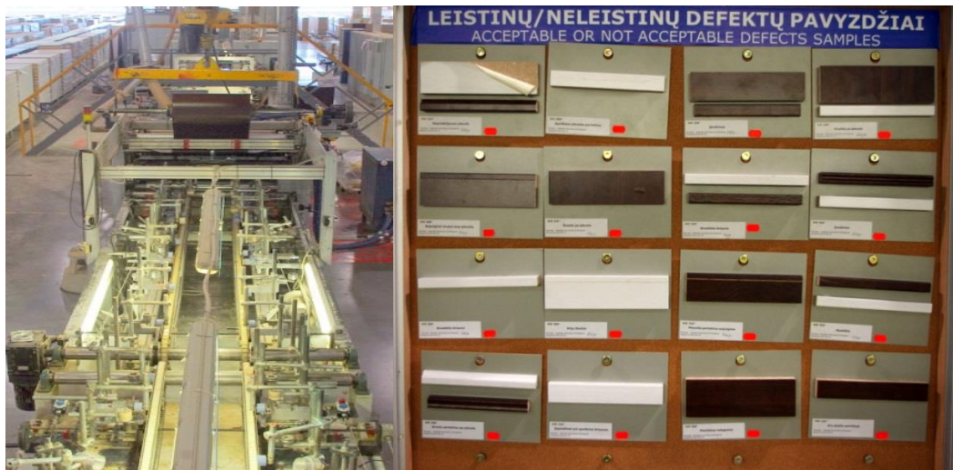
1 pav. Laminavimo linija ir defektų pavyzdžių lentelė
