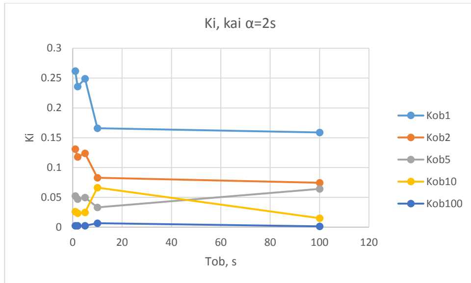
2.8 pav. Regulatoriaus koeficiento K_i priklausomybė nuo objekto laiko pastoviosios prie skirtingų objekto stiprinimo K_{ob} reikšmių ir kuomet objekto vėlinimas 2 sekundės
