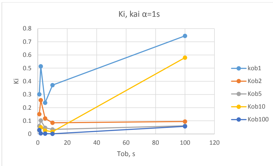
2.6 pav. Regulatoriaus koeficiento K_i priklausomybė nuo objekto laiko pastoviosios prie skirtingų objekto stiprinimo K_{ob} reikšmių ir kuomet objekto vėlinimas 1 sekundė
