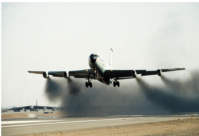
1.1 pav. Lėktuvas paliekantis didelius juodus debesis nesudegusių degalų dėl vandens įpurškimo sistemos naudojimo pakilimo metu [17]
