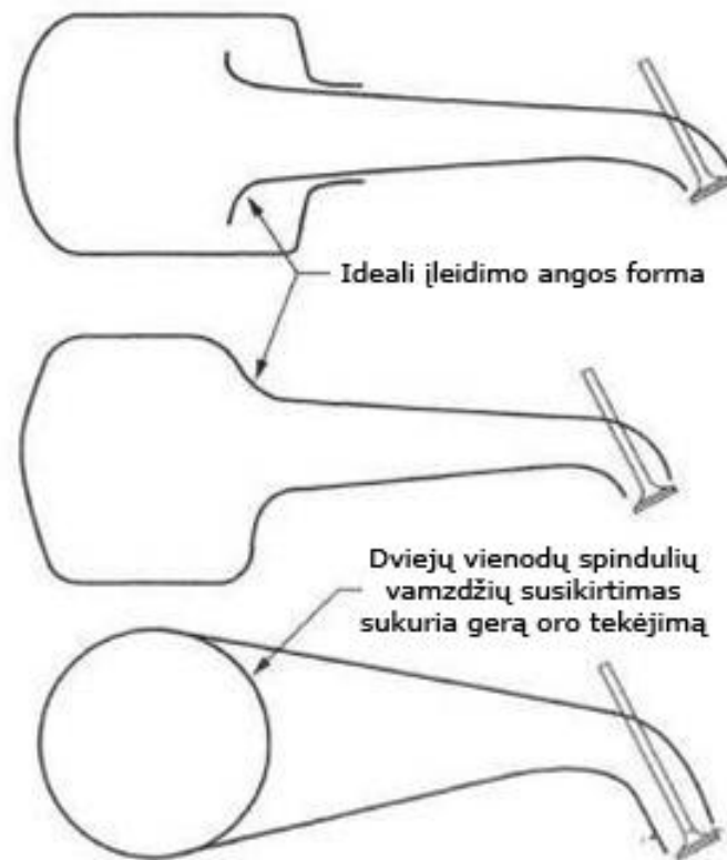
1.16 pav. Plenumo ir išsišakojimo sankirtos forma turi būti arti idealios oro įleidimo formos [3]
