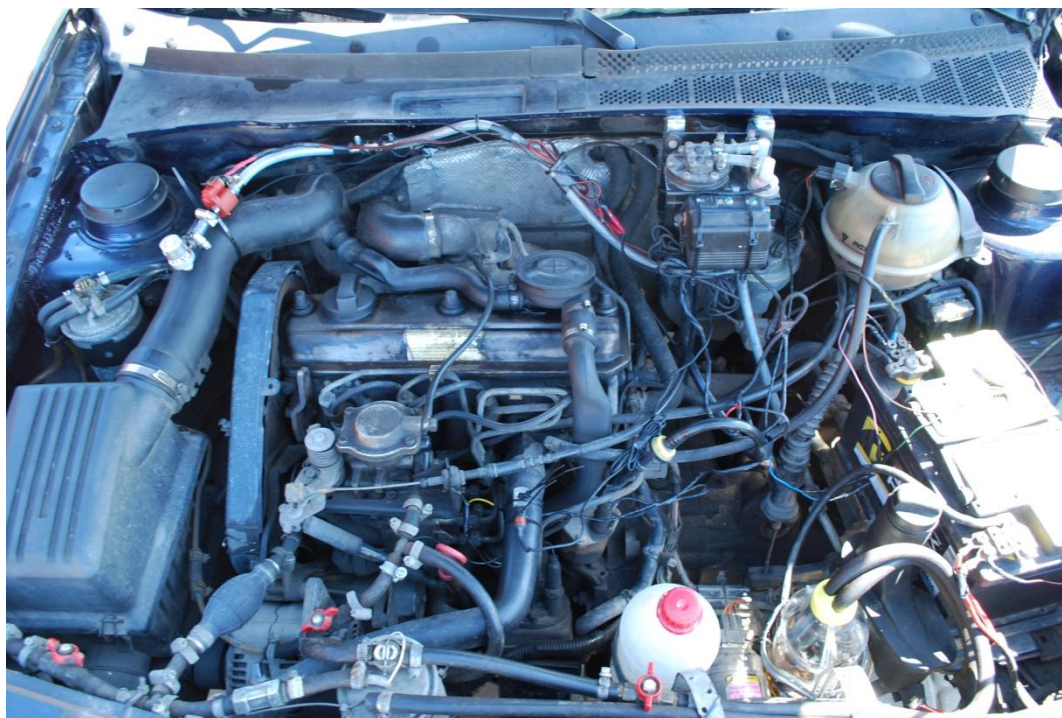
3.1 pav. Sumontuota vandens įpurškimo sistema
