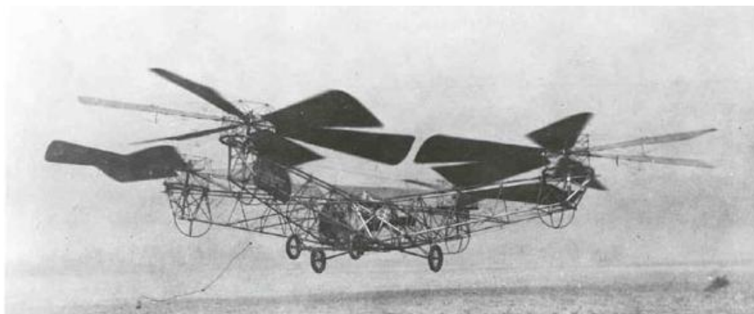
6 pav. Georges de Bothezat ir Ivan Jerome kvadrokopteris [6]
