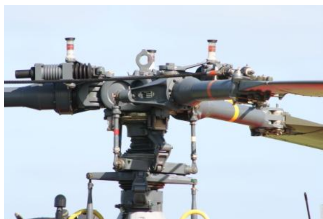
3 pav. Sraigtasparnio pagrindinis rotorius [14]
