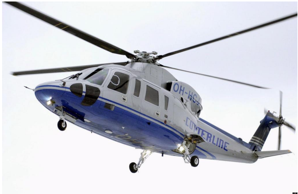
2 pav. Vieno rotoriaus sraigtasparnis [13]
