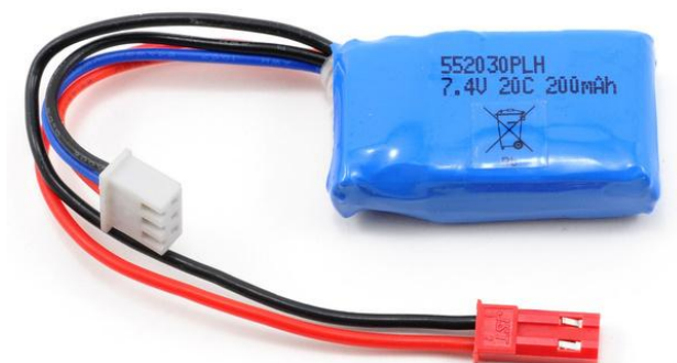
14 pav. 2 sekcijų ličio polimerų akumuliatorius
