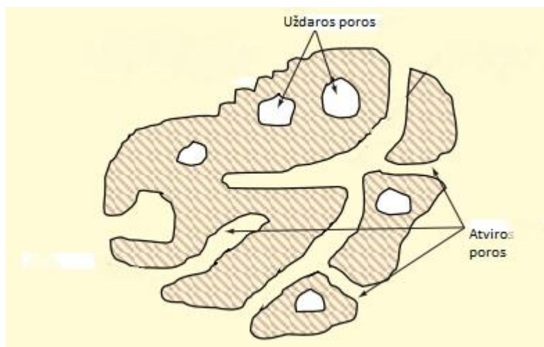
20 pav. Porėtos medžiagos skerspjūvis [18]
