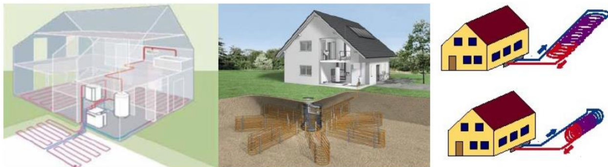
2.2 pav. Horizontaliųjų kolektorių tipai
