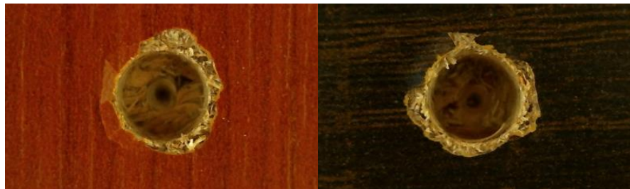
5 pav. Pažeista laminuota danga aplink skylę
