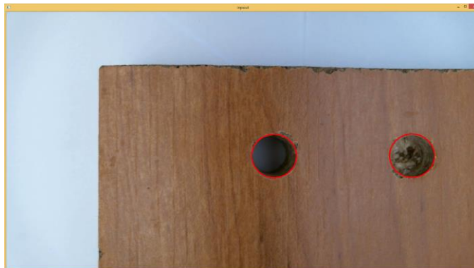
39 pav. Taikant mažiausių kvadratų metodą rastos skylės detalėje
