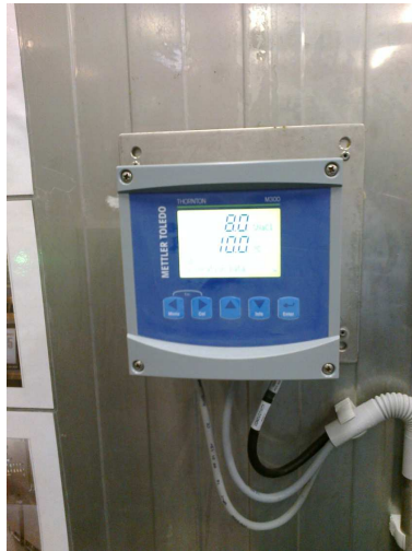
1.2 pav. a) Tirpalo koncentracijos įvedimo ir atvaizdavimo įrenginys
