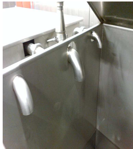
b) Maišymo talpos įeinantys vamzdžiai (iš kairės pusės: pamaišymo, koncentrato, vandens)
