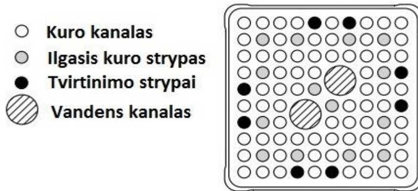
4.1 pav. ABWR kuro kasetės pjūvis.
