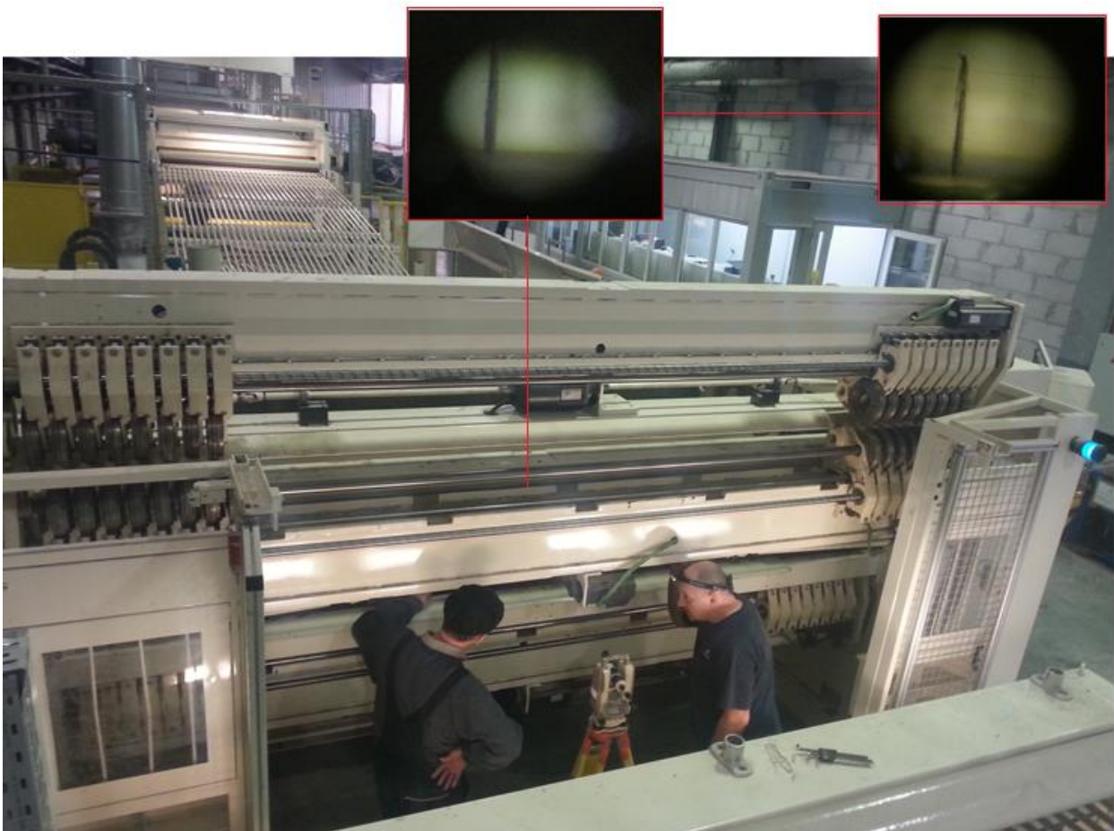
3.2.2 pav. elektroninio teodolito optiniame okuliare matomas vaizdas išskirtas viršuje.
