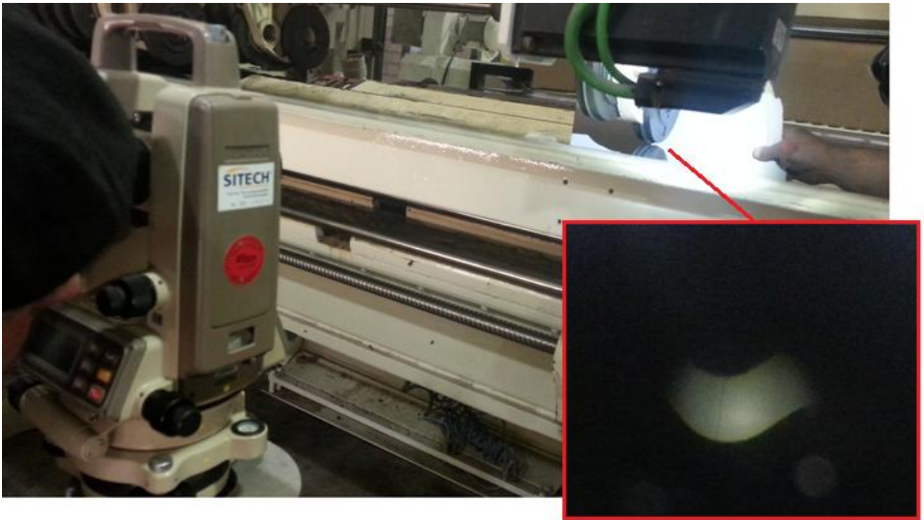
3.2.1 pav. elektroninio teodolito optiniame okuliare matomas vaizdas išskirtas raudoname kvadrate.
