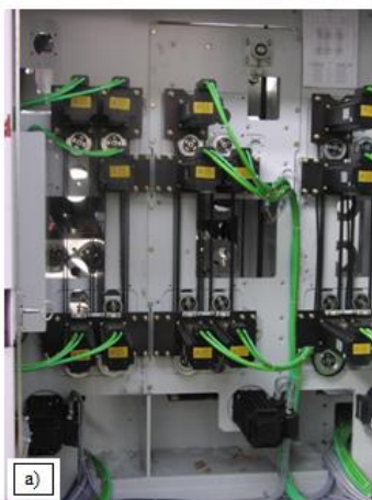
3.4 pav. techninė įranga: ELAU pozicionavimui įrankių angl. Multi turn encoder: encoderis yra integruotas variklio korpuse fiksuotas rotoriaus gale.
