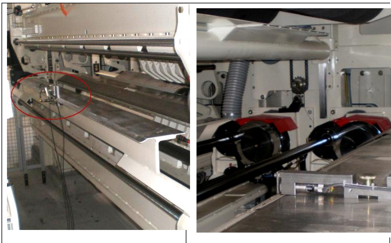
3.4.1 pav. pavaizduotas siūstuvas (dešinėje), signalų priimtuvas (kairėje).
