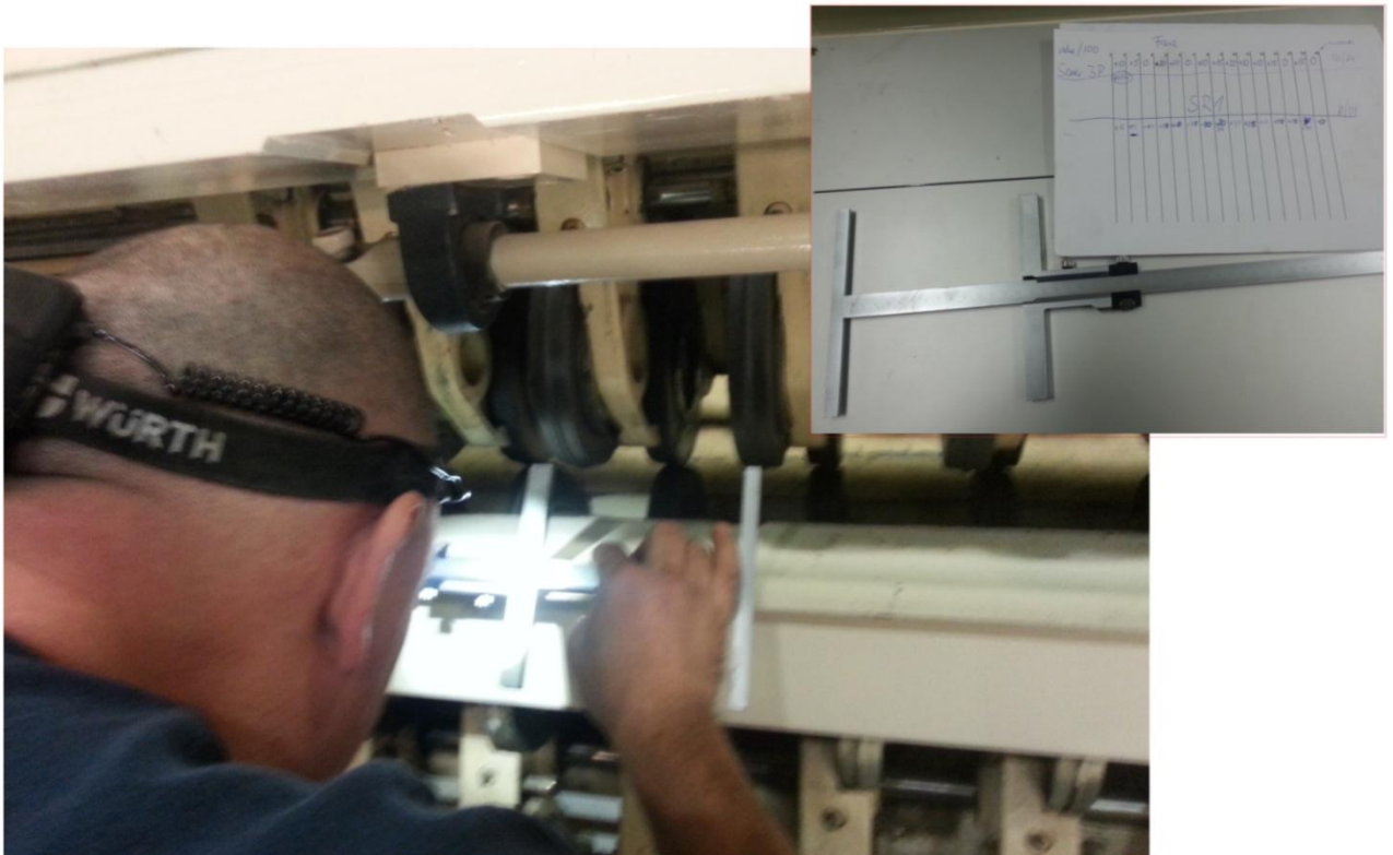
3.3.1 pav. matavimai tarp įrankių centrų atliekami specialaus slankmačio pagalba.
