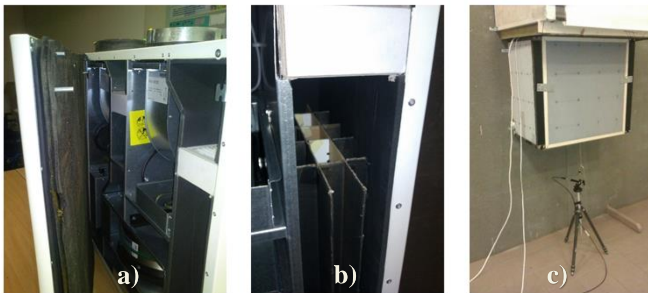
Pav. 3.21 Rekuperatoriaus korpuso konstrukciniai pakeitimai: a – priekinė sienelė iš vidaus padengta mikroporine guma (storis 10 mm); b – dešinės pusės sienelės sustandinimas pertvara iš vidaus; c – įrenginio visos korpuso paviršius iš išorės padengiamas garso izoliacine medžiaga.
