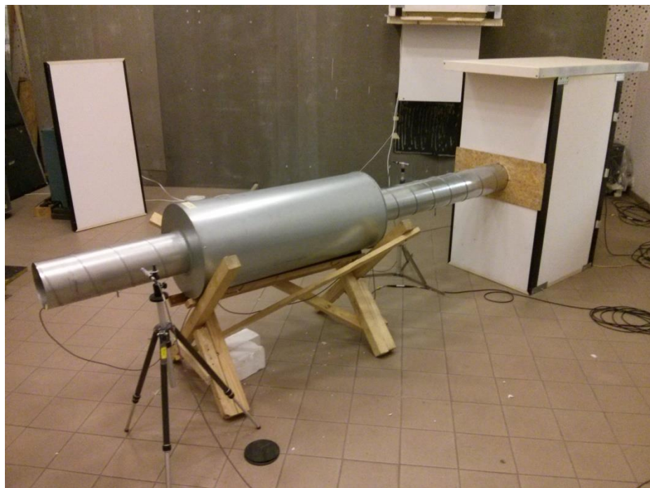
Pav. 3.17 Bandyto vaizdas, kai matuojami apvalūs kanaliniai slopintuvai
