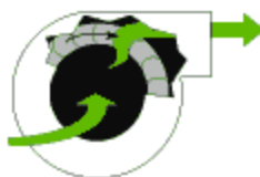
Pav. 2.15 Išcentrinis ventiliatorius su į priekį lenktais sparneliais
