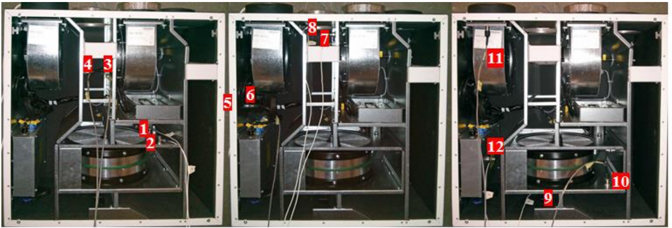
Pav. 3.8 Vidinių sienelių matavimo daviklių pozicijos išdėliotos matavimo vietose
