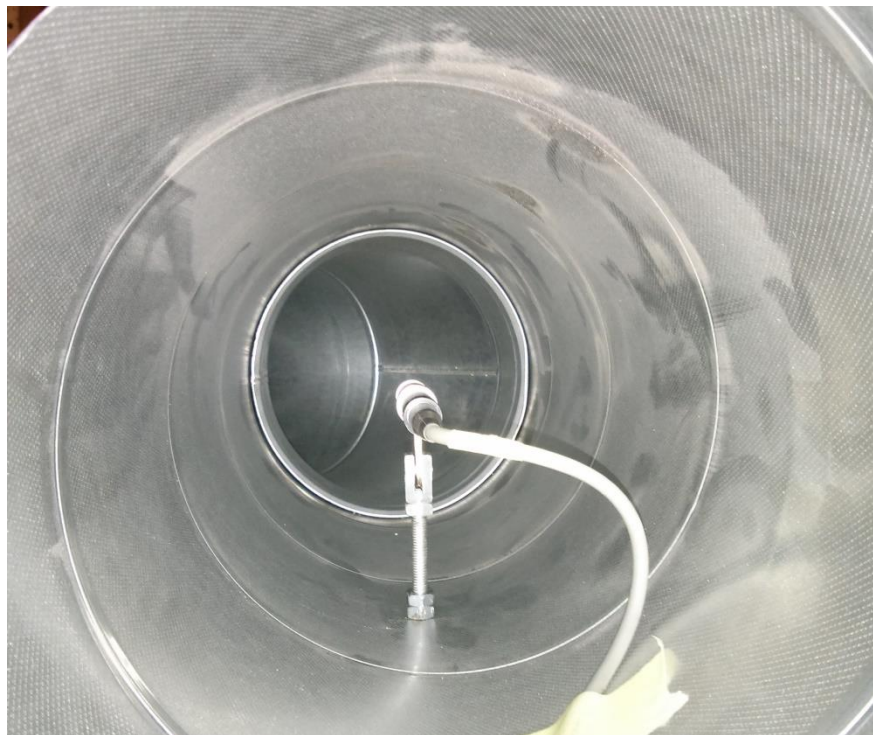
Pav. 3.20 Mikrofono tvirtinimas ortakio viduje
