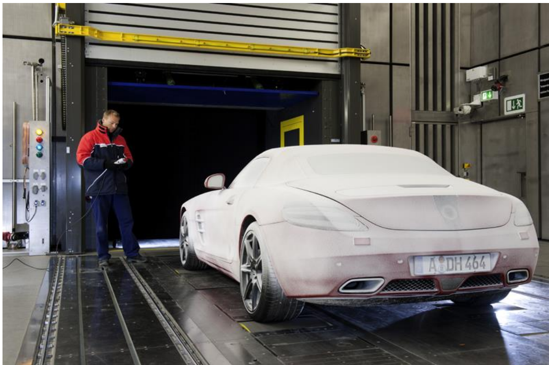
11 pav. vėjo tunelis su modeliu, kurio ratai yra pastatomi ant besisukančių volų [24]
