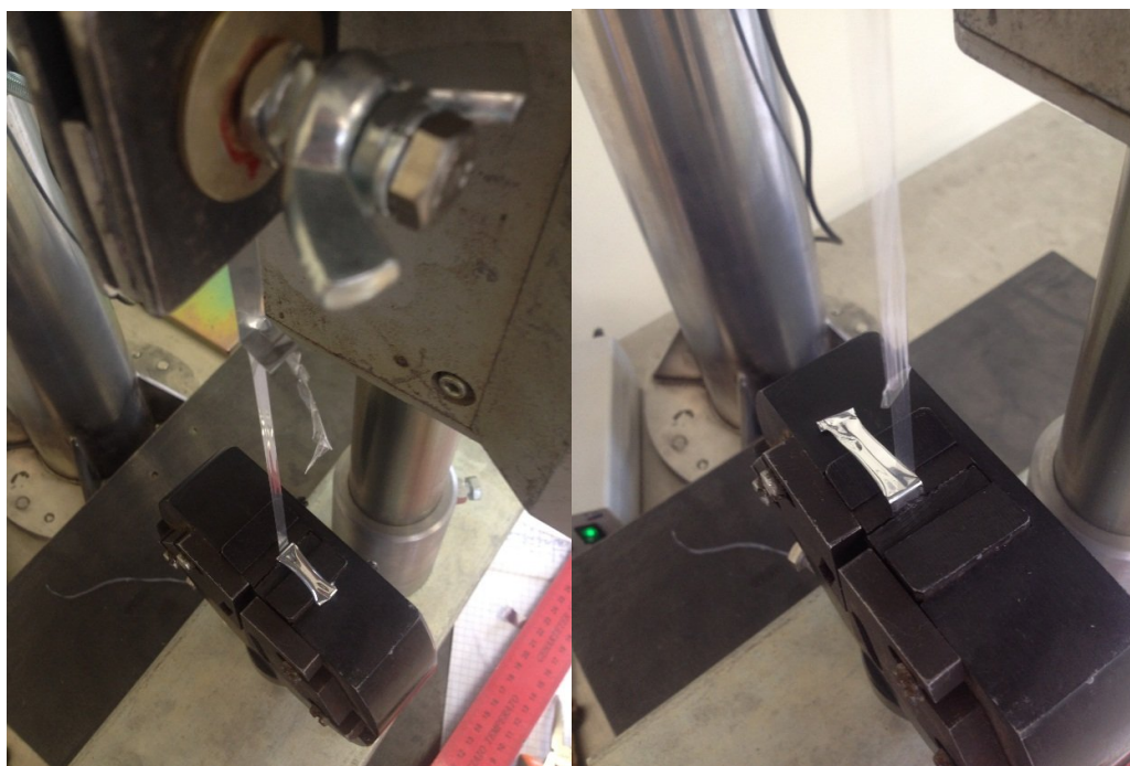
19 pav. Polietileno atsiskuoksnimas nuo aliuminio sluoksnio
