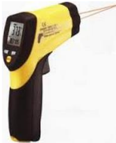
19 pav. bekontaktis termometras EMSiTest – 8865 [10].
