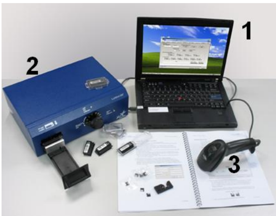
3.18 pav. Portabilus dozimetr nuskaitym renginys MicroStar
