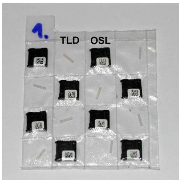
4.5 pav. Optiškai stimuliuojamos liuminescencijos (OSL) dozimetras ir termoliuminescencini dozimetras (TLD) 4x4 dydžio matrica
