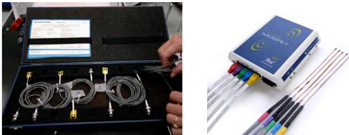
3.9 pav. Puslaidininkiniai p-Si ir MOSFET dozimetrai
