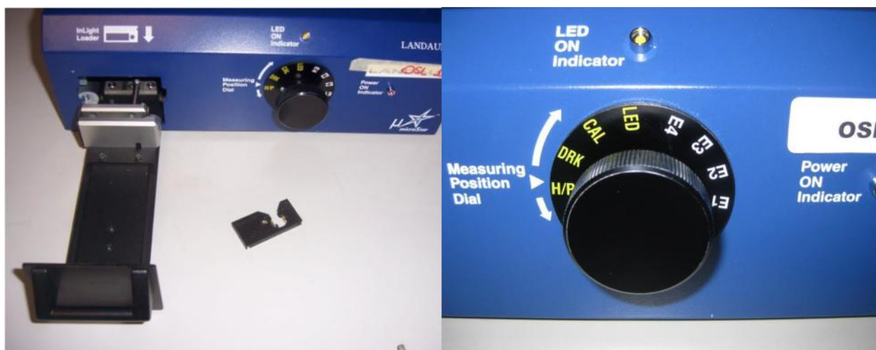
3.19 pav. Dozimetr stal ius su adapteriu (kair je) ir nuskaitymo paleidimo svirtis (dešin je)
