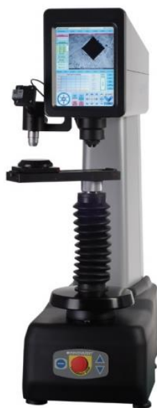
3.2 pav. Bendras kietumo matuoklio „Verzur 750CCD“ vaizdas [15]
