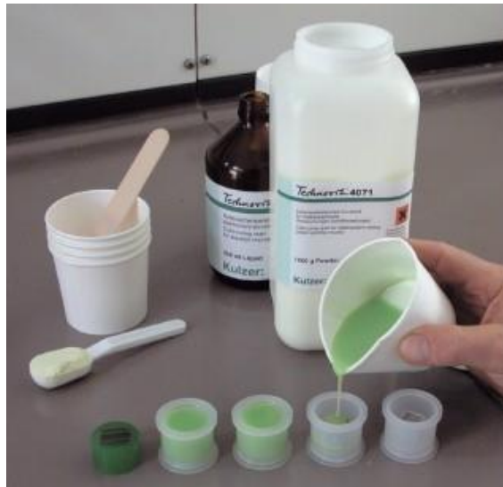
3.5 pav. Bandinių įliejimas į plastiką „Technovit“ [16]
