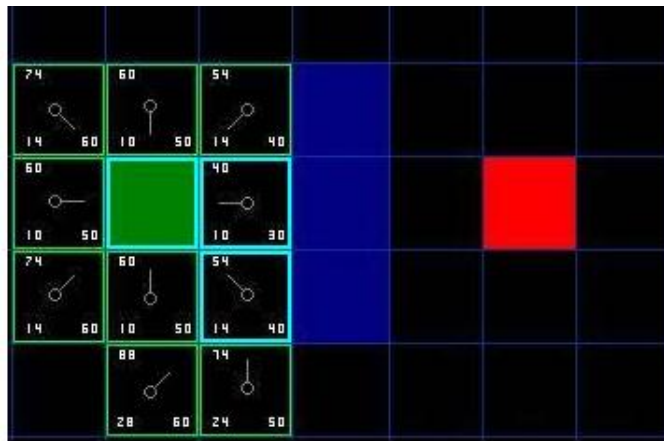
1.5 pav. Tolimesnis skaičiavimas A* algoritmu [3].
