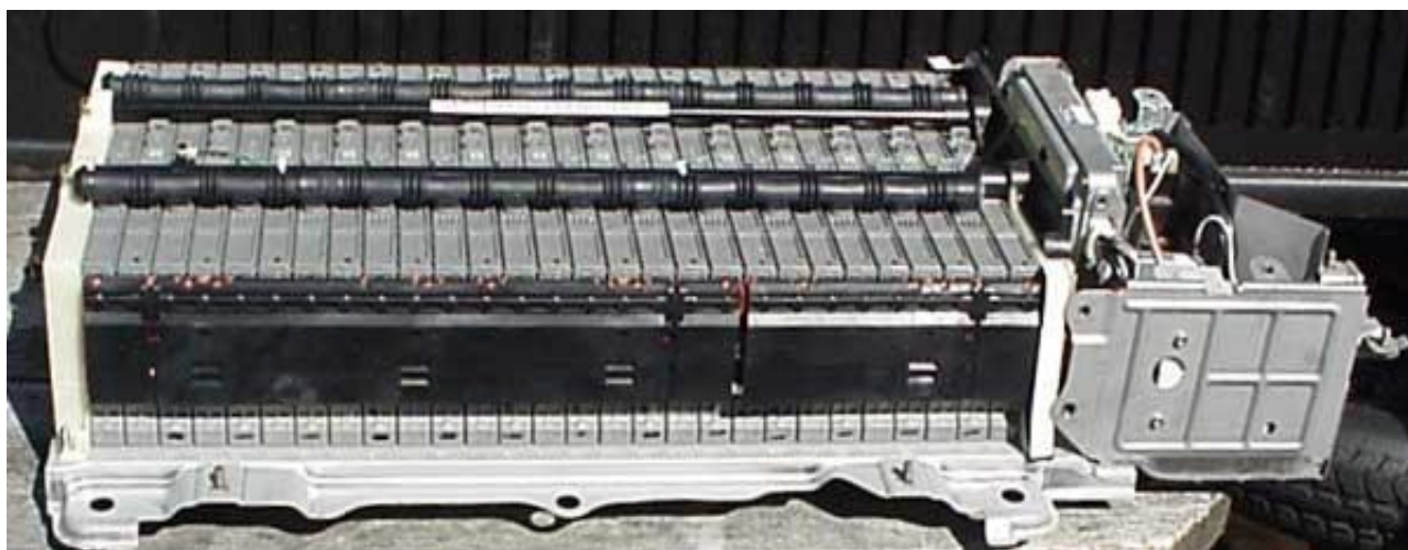
1.12 pav. Antros kartos Toyota Prius NiMh aukštos įtampos traukos akumuliatorius [9]
