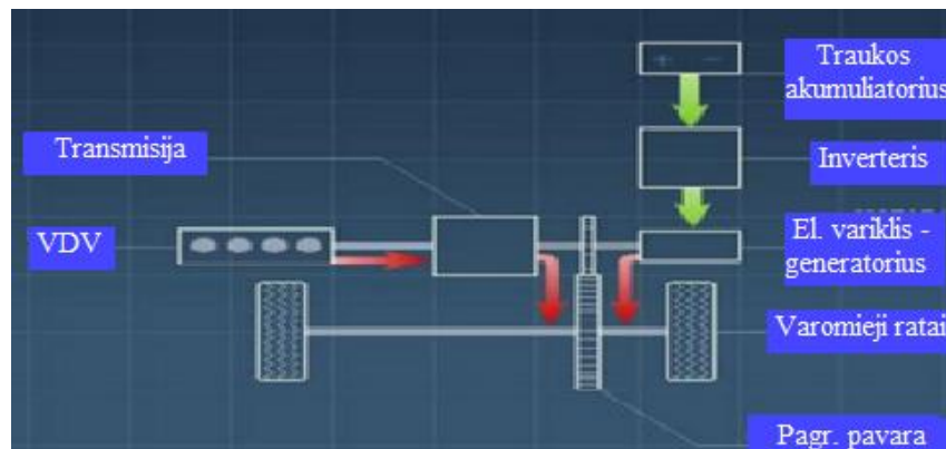
1.8 pav. Lygiagreči HA pavarų komponavimo schema [18]
