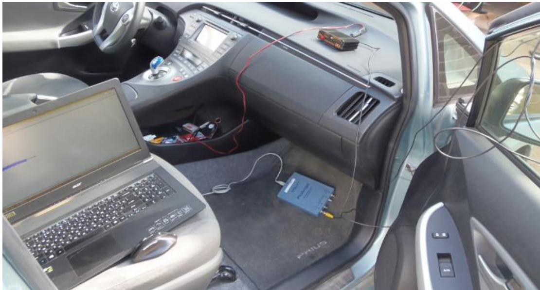
2.2 pav. „DL1 Data Logger“ matavimo prietaiso lokalizacija bei matavimo prijungimas.
