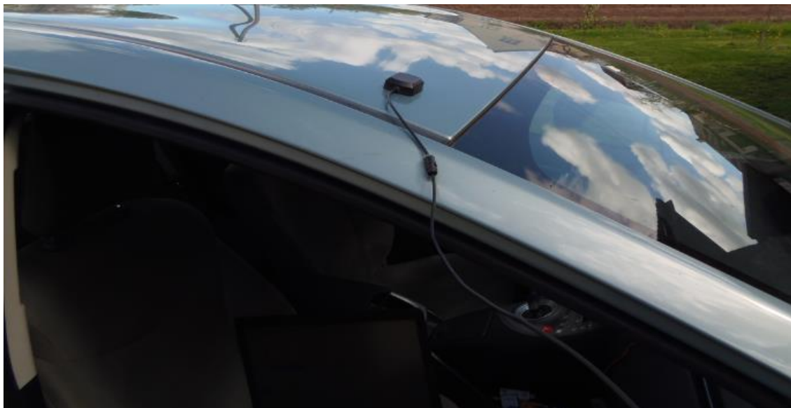
2.3 pav. „DL1 Data Logger“ matavimo prietaiso GPS antenos tvirtinimas ant automobilio stogo.
