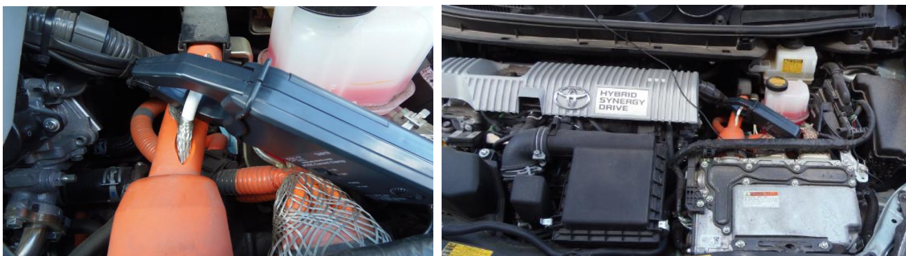
2.7 pav. Srovės matavimo replės: a – jų uždėjimas ant galios kabelio; b – jų vaizdas kartu su variklio skyriumi
