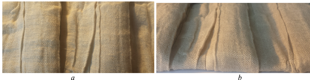
5.1.9 pav. Dvisluoksnis audinys pripildytas sinteponu: a – vaizdas iš viršaus, b – vaizdas iš šono
