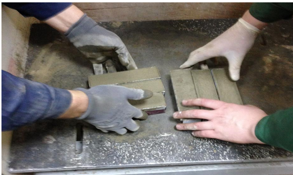
19 pav. vibruojamos formos ant vibracinio stalo
