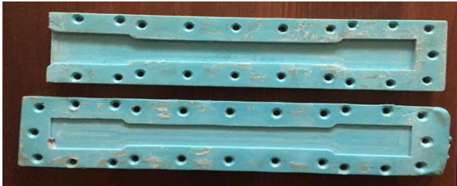
16 pav. Forma stiklo pluošto ir dervos bandiniui
