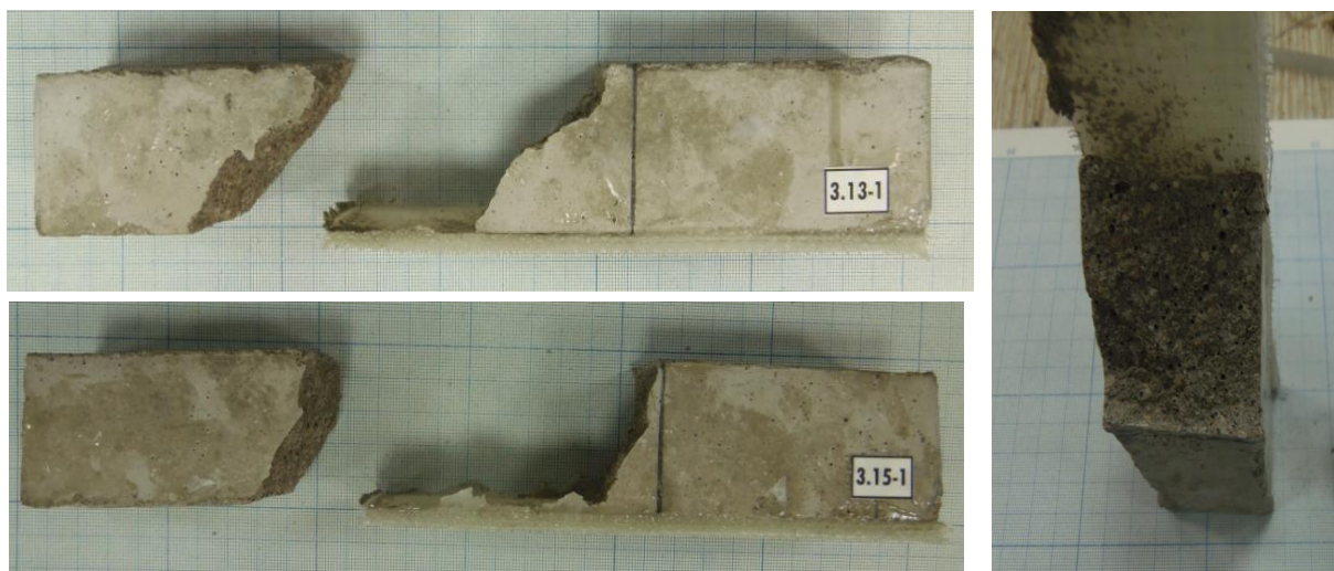
29 pav. 18 sluoksnių armuotos konstrukcijos suirimas
