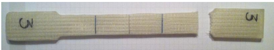
37 pav. Pertraukts stiklo pluošto ir epoksidinēs dervos bandinys
