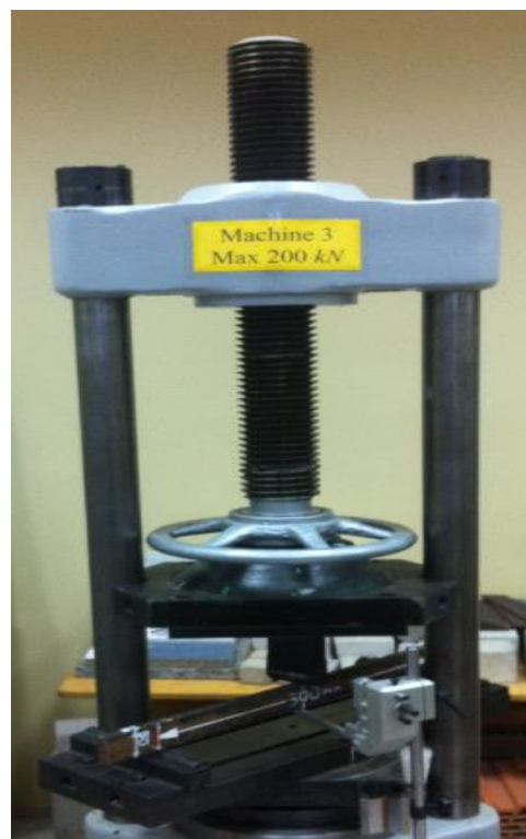
17 pav. Lenkimo presas Walter+bai AG ir poslinkio daviklis, ir gniuždymo presas BRÜTSCH/RÜEGGER
