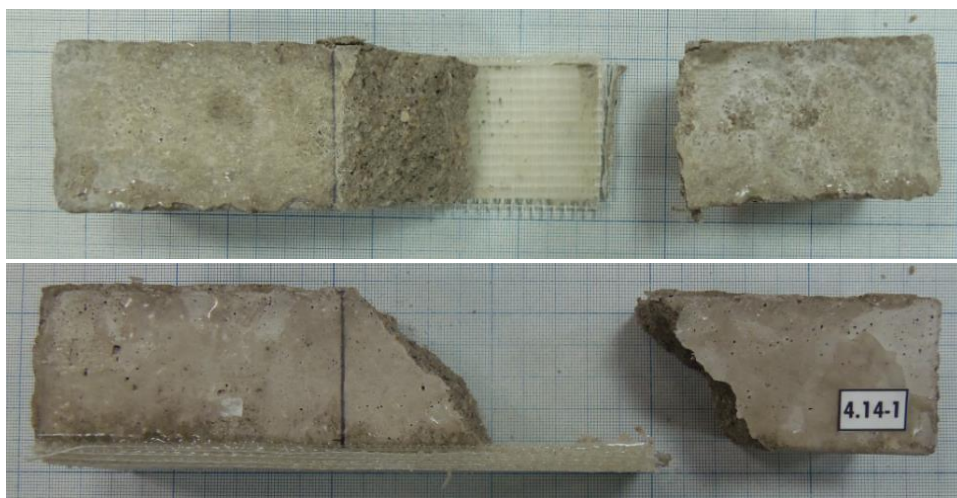
32 pav. 24 sluoksnių armuotos konstrukcijos suirimas
