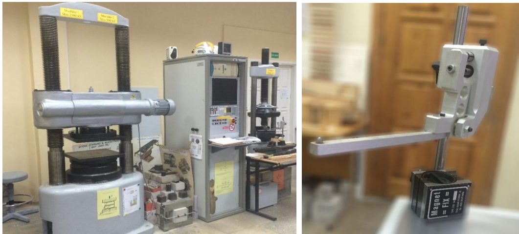
21 pav. Gniuždymo mašina Walter+bai AG ir poslinkio daviklis BRÜTSCH/RÜEGGER
