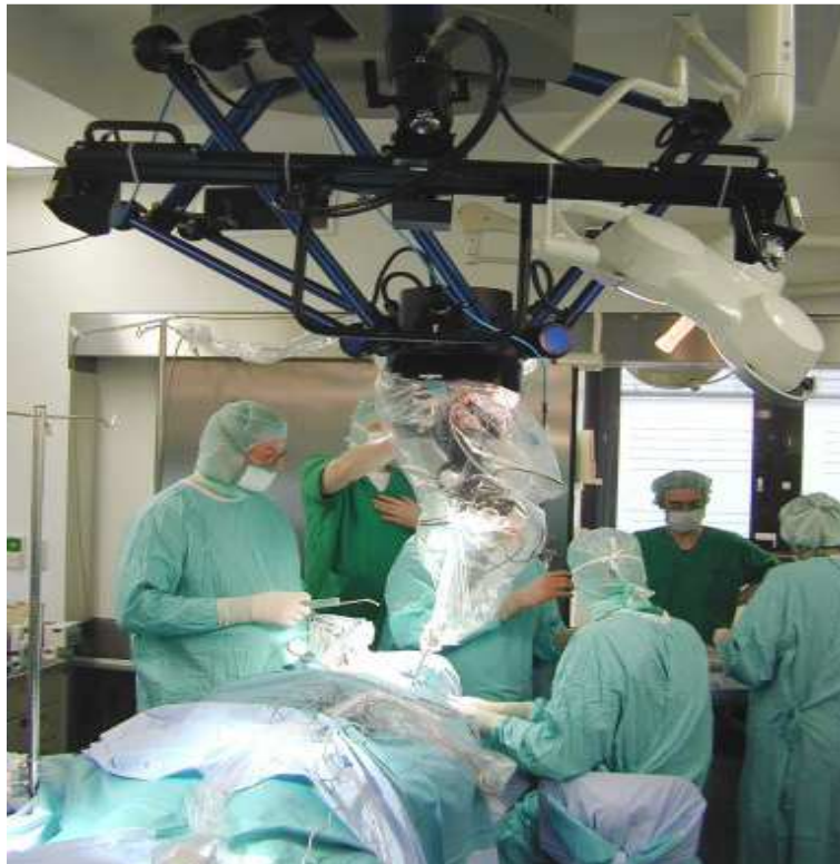
12 pav. „SurgiScope“ delta robotas naudojamas operacijos metu [9]
