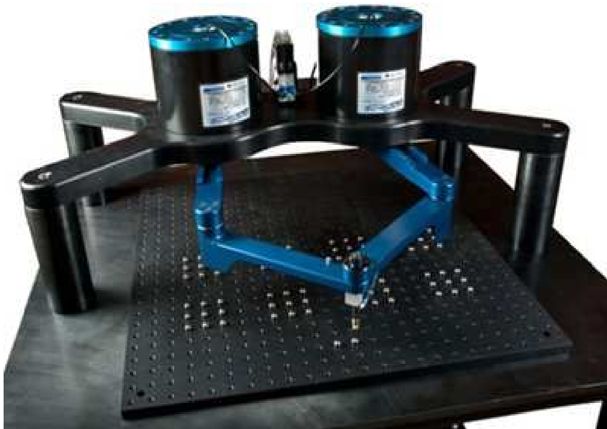
13 pav. Tyrimams naudojamas paralelinis robotas DexTAR [12]
