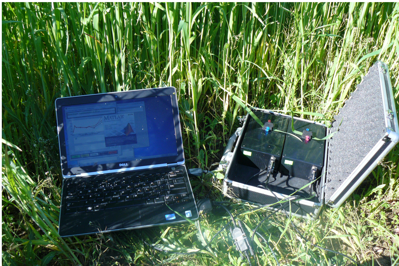
2.4.6 pav. Spektrofotometriniu augalų augimo diagnostikos prietaiso prototipu atliekami matavimai kviečių laukuose.
