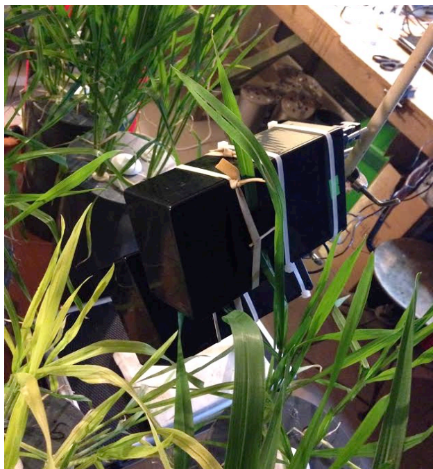
2.4.5 pav. Spektrofotometrinio augalų augimo diagnostikos prietaiso prototipu matuojami vasarinių kviečių lapai UAB „Žemdirbių konsultacijos“ laboratorijoje.
