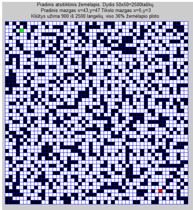
38 pav. Testavimui sugeneruotas 50x50 langelių dydžio atsitiktinis žemėlapis su 36% kliūčių tankumu, pradinis taškas x=43 , y=47 , galutinis x=5 y=3 .
