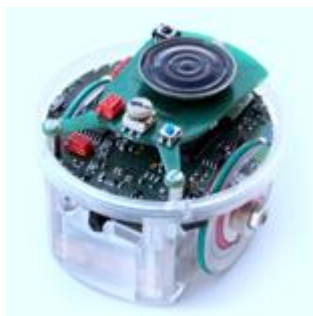
64 pav. Mobilus autonominis robotas E-puck.
