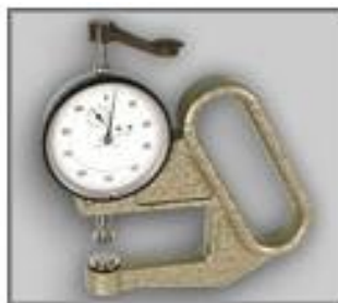
2.2. pav. Storio matavimo prietaisas „Schmidt control“ [49]
