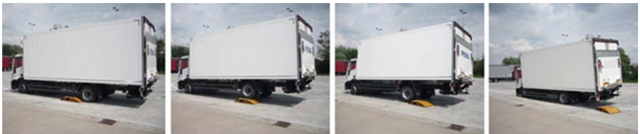
20 pav. Sunkvežimio važiuojama per 190mm aukšio trapecinio pakylą [7]
