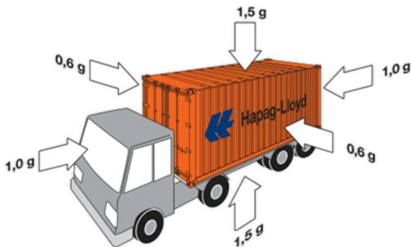
3 pav. Galimi pagreities reikšmės transportuojant sunkvežimiais [2]. Čia g = 9,81 \text{ m/s}^2 – laisvojo kritimo pagreitis
