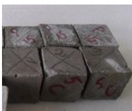
16 pav. Cemento ir ceolito gniuždymo bandiniai
