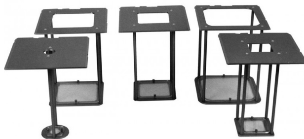
3.2 pav. Varian greitintuvuose naudojamų elektronų spinduliuotės aplikatorių pavyzdžiai. Šaltinis: http://www.rpdinc.com/3568-thickbox/electron-cone-set-.jpg
