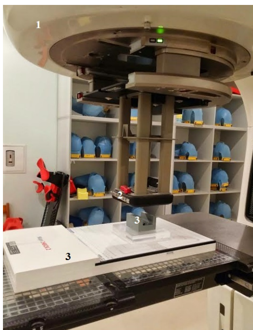
3.9 pav. Pagaminto boliuso dozimetrinių matavimų schema 2D detektorių matrica Mapcheck2. 1 - greitintuvo gydymo galva, 2- elektronų pluošto aplikatorius, 3 - pagamintas boliusas, 3 - MapCheck2
