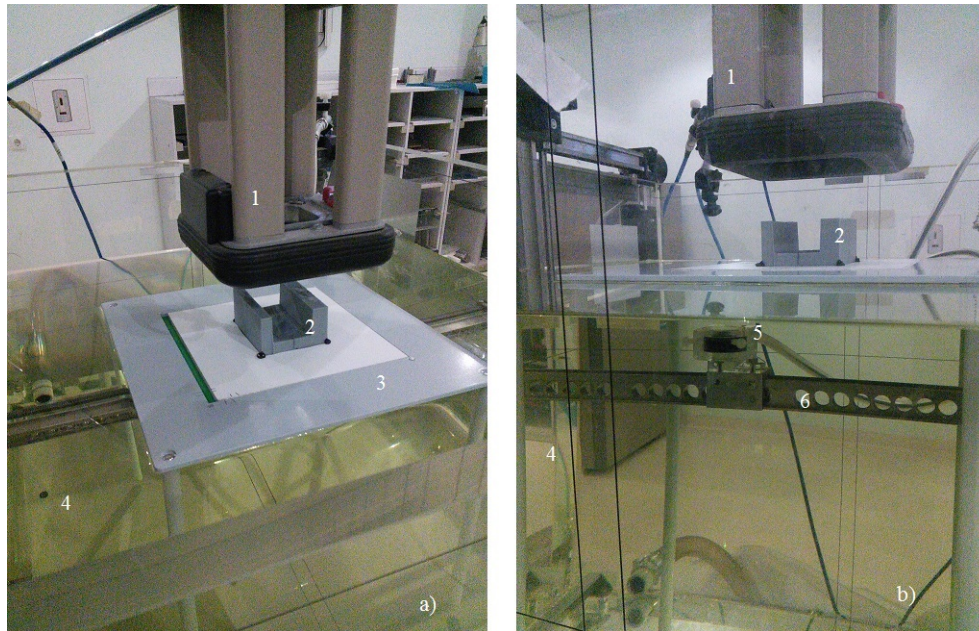
3.8 pav. Pagaminto boliuso dozimetrinių matavimų schema skenuojančiu vandens fantomu: a) vaizdas iš viršaus, b) vaizdas iš šono. 1 - elektronų pluošto aplikatorius, 2 - pagamintas boliusas, 3 - boliuso padėklas, 4 - vanduo, 5 - Markus PTW jonizacinė kamera, 6 - jonizacinės kameros skersinio skenavimo ašis
