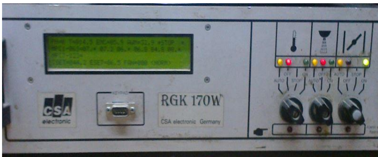
14 pav. Kompiuterinis valdiklis (RGK 170, CSA electronic, Vokietija)
