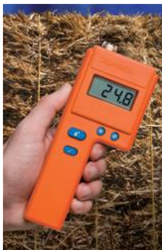
1.5 pav. Šieno bei medienos drėgmės matuoklis FX 2000
