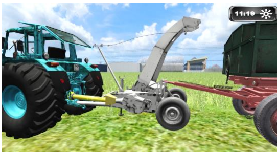
1.4 pav. Pusiau pakabinamas žolės smulkintuvas [3]
