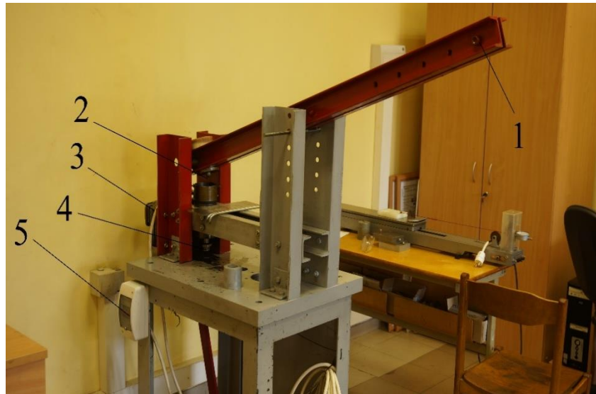
3.2 pav. Tribologinis stendas guolių tyrimui: 1 – svorio tvirtinimo vieta, 2 – jėgos pridėtinės taškas į suklio ašį per atraminio guolio guoliavietę, 3 – elektros variklis, 4 – bandomojo guolio guoliavietė, 5 – jungiklis.
