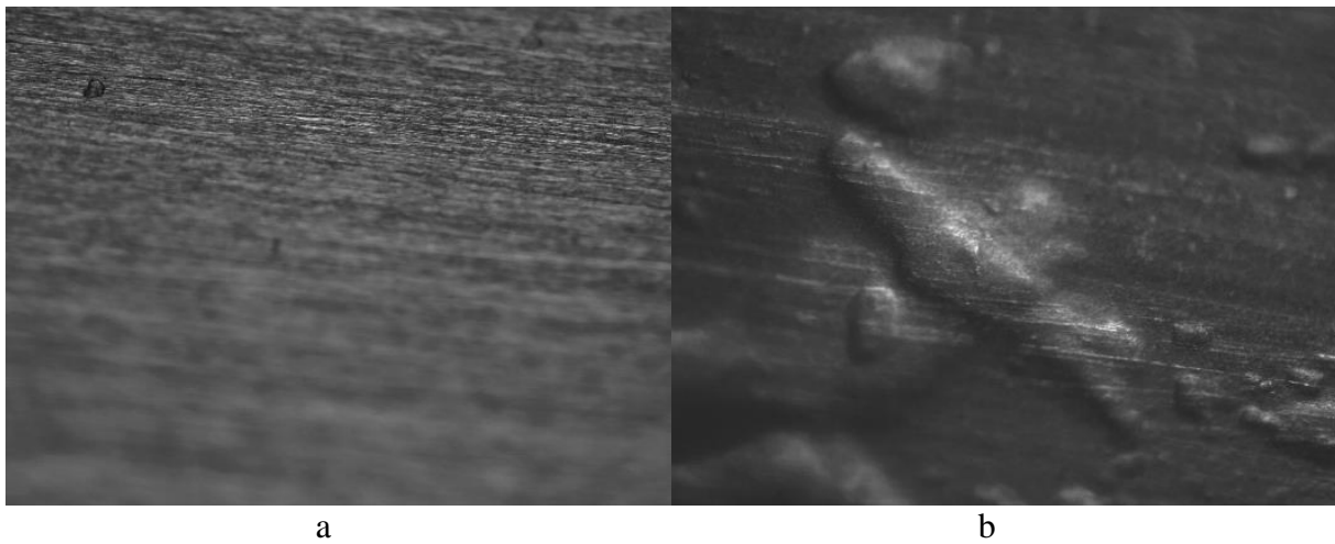
4.11 pav, Išorinio žiedo darbinio paviršiaus kokybė: a – pradinis, b – po 360 000 ciklų,
