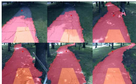
12 pav. Automatinės kelio segmentavimo sistemos veikimas keičiantis kelio formai [9]
