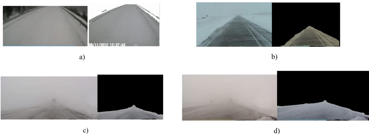
52 pav. Kelio dangos segmentavimo rezultatai esant prastam matomumui (pradinis kadras kairėje, rezultatai dešinėje): a – visiškai sniegu padengta kelio danga; b – mažu sniego kiekiu padengta kelio danga; c – mažu sniego kiekiu padengta kelio danga esant pūgai; d – kelio danga esant pūgai
