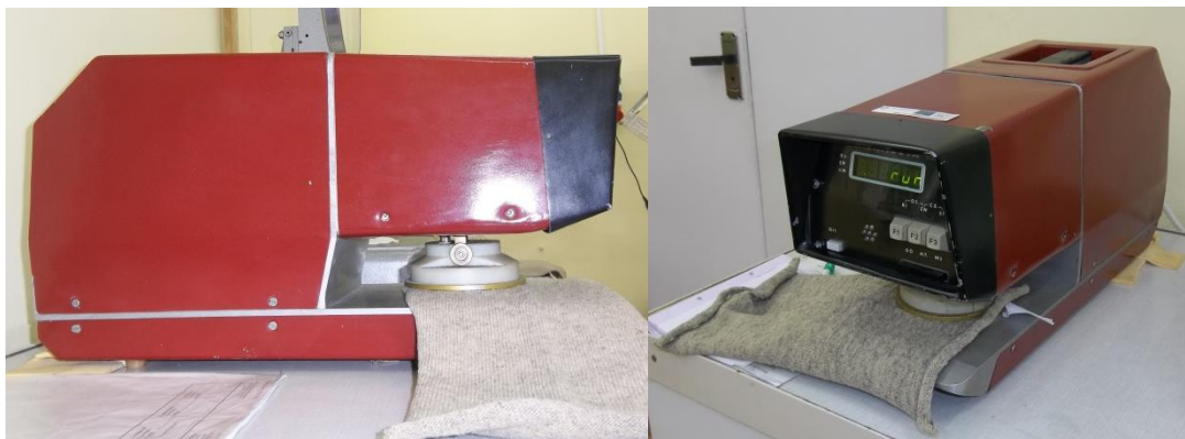
2.2.2 pav. Mezginių šiluminių savybių tyrimas Alambeta prietaisu
